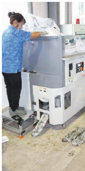
導入された発泡スチロール減容機
