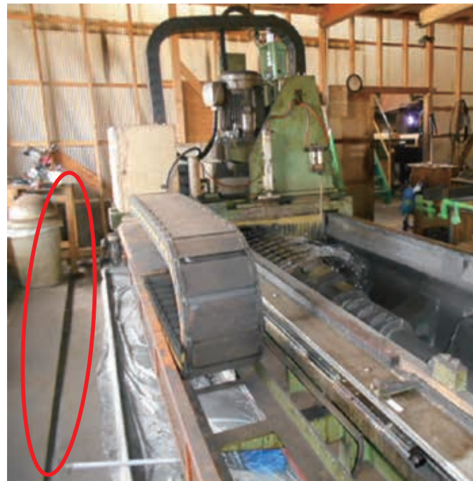
研磨機 地盤沈下 約5cm (写真奥側に向けて沈下が進んでいる)
