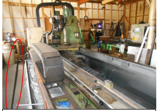
研磨機 地盤沈下 約5cm (写真奥側に向けて沈下が進んでいる)
