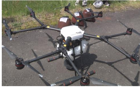
重さ 10kg まで搭載できる 小型無人機ドローン
