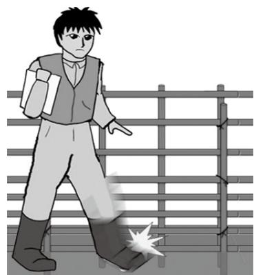
柵の下部を蹴り、揺れが大きき、または揺れが収まらない場合は、柵が地面に刺さっていないか下部の腐食・獣による持ち上げなどが考えられます。
