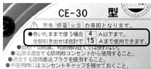
コードリールにはコードを巻いたまま使用できる電流量とコードを全て引き出して使用できる電流量があります。コードを全て引き出した方が、より多くの電流を流せます。安全のためにもコードは全て引き出して、延長コードなども丸めて使わずに伸ばして使しましょう。
