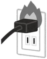
りがたまり、そのほこりが空気中の湿気を吸収することで漏電し、少しずつ炭化が進むことでその部分が電気を通しやすくなり、突然電極間がショートし発火する現象です。
