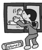
窓ガラスの飛散防止
