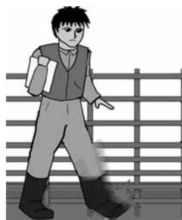
柵の下部を蹴った時に、揺れや振動があれば、地面に刺せていない・下部の腐食・獣による持ち上げなどが考えられます。
