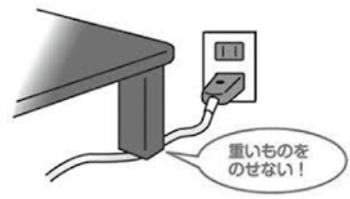
【例】配線が家具に挟まれたり、釘などで配線を強く固定したりしたことにより配線が一部損傷して出火する。
